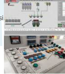
*Tam otomatik çalışma sistemi, *Tartım indikatörü çok kullanışlı ve kolay arayüz *Yazılım (Kabiness) *İstenen raporların hazırlanması ve çıktı alınması
